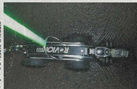
発電所の放流管ハッチから自走式テレビカメラ(ロビオン)を挿入する
